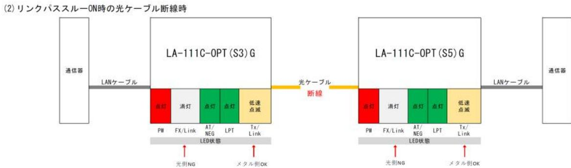
電気室側、現場側共にTx/Link用LEDが低速点滅となっており、Fx/Link用LEDが消灯している場合、光ケーブルに障害が発生していることがわかる。
