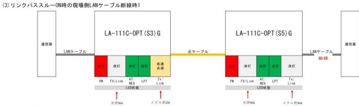
電気室側のTx/Link用LEDが低速点滅をしており、現場側のTx/Link用LEDが消灯していた場合、現場側のLANケーブルに障害が発生していることがわかる。
