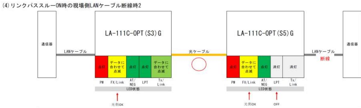
現場側のリンクバススルーをOFFにし、電気室側、現場側共のFx/Link用LEDがデータに合わせて点滅していた場合、光ケーブルには障害が発生していないことがわかる。
