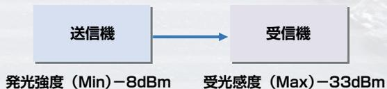
許容損失 =  $-8\text{dBm} - (-33\text{dBm}) = 25\text{dB}$
