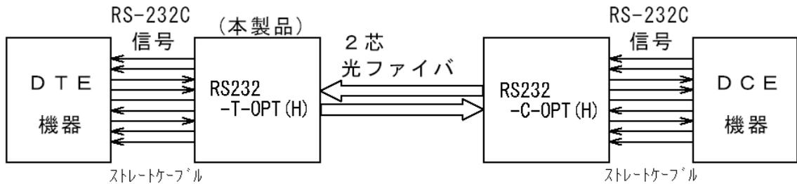
このときのDTE及びDCE機器間の接続状態は下図の通りになる。
