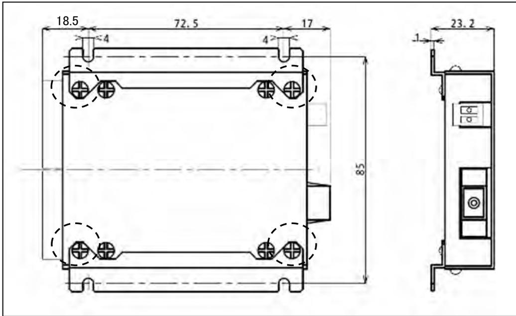
取付板をご使用にならない場合には、点線丸部のネジを外して、取付板を取外してください。
