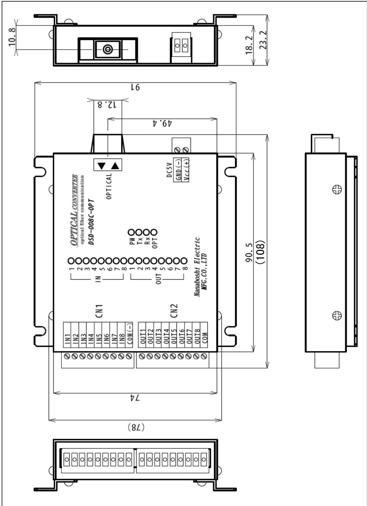
1 3 - 2. 標準取付板装着時の取付寸法(送受共通)
